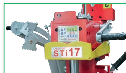
2-Hand-Bedienung (Schalten und Halten) Zusätzliche Hand zum Holzhalten
