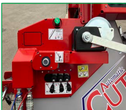
Geschwindigkeitsverstellung des Förderbands
