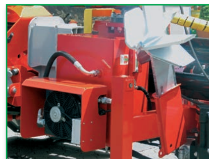
Ölkühler mit Spaltkreuzhalterung
