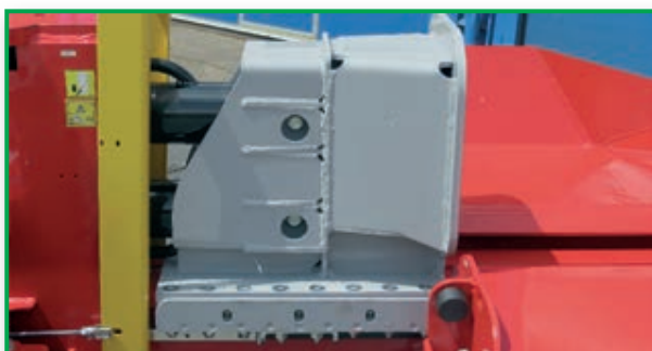
große hochwertige Führung mit Schmiernippel
