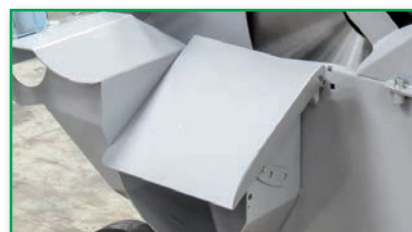
Verstellung der seitlichen Holzrutsche von 0-45 Grad
