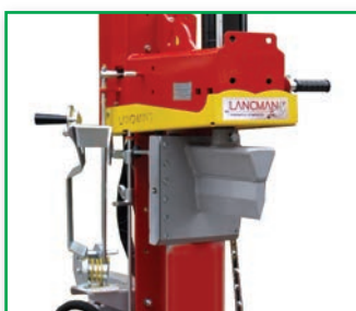
2-Hand-Bedienung (Schalten und Halten) Zusätzliche Kralle zum Holzhalten
