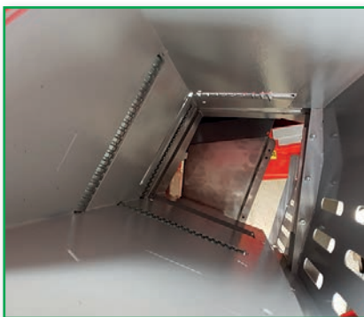
Rollen für optimales Nachrutschen des Holzes
