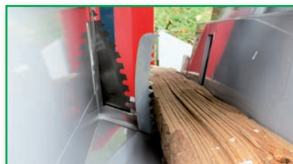
Niederhalter für Fixierung des Holzes.
